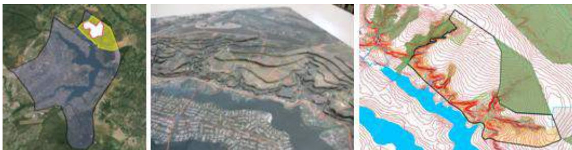
Figura 8. Imagem aérea da Gleba A do Etapa 2 e as curvas de nível demonstrando o caminho das águas em direção aos córregos e ao Lago Paranoá. Fonte: Shinelle Hills e TERRACAP (2013).
