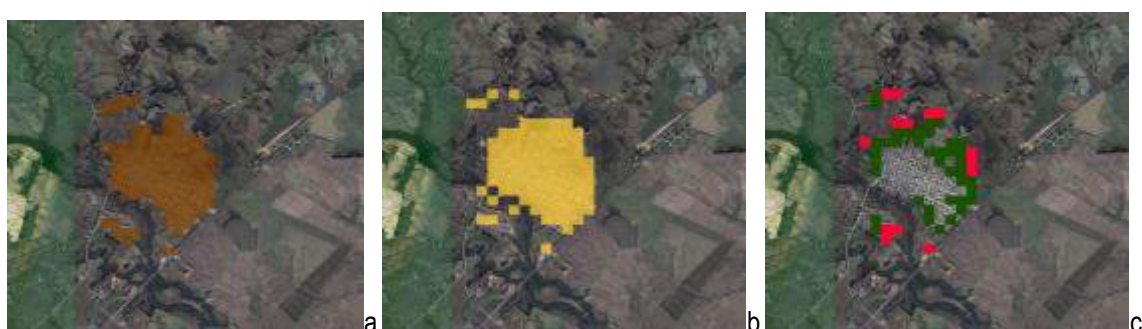
Figura 5. Resultados visuais obtidos na calibração para Arroio Grande; a) área efetivamente urbanizada real, em 2010; b) resultados obtidos na simulação, iteração 39; c) mapeamento de acertos na simulação, iteração 39, com os acertos em verde e os erros em vermelho, com raio igual a 1.
