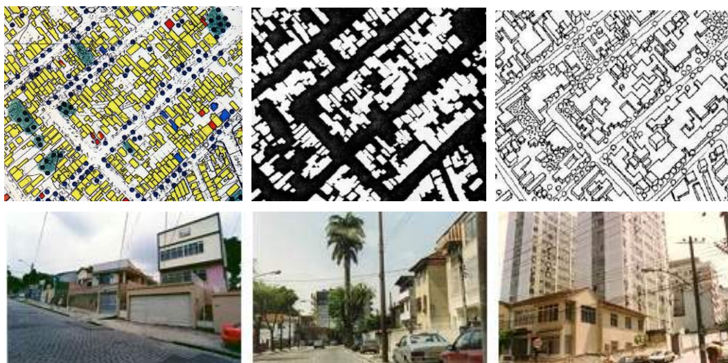
Figura 11. Análise morfológica e tipológica para subúrbios do Rio de Janeiro – demonstrando traçados urbanos uniformes e volumetrias heterogêneas, com predominância de ocupação horizontal.
