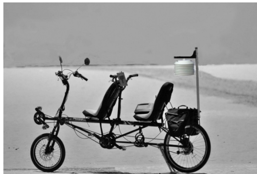
Figura 3. Bicicleta utilizada durante as medições, Meteobike .
